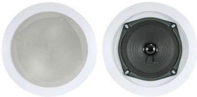
Altoparlante da incasso con impedenza 8 ohm. Woofer: 5 1/4" paper cone, power line 100 V / 8 Ohm: 6 W, risposta in frequenza: 150 Hz ~ 15.000 Hz , sensibilità: 91dB @ 1W / 1m, dimensioni: 190 mm (diametro cornice) x 102 mm (profondità), dimensioni foro da incasso: Ø 175 mm, peso: 0,8 kg. Colore: bianco.
