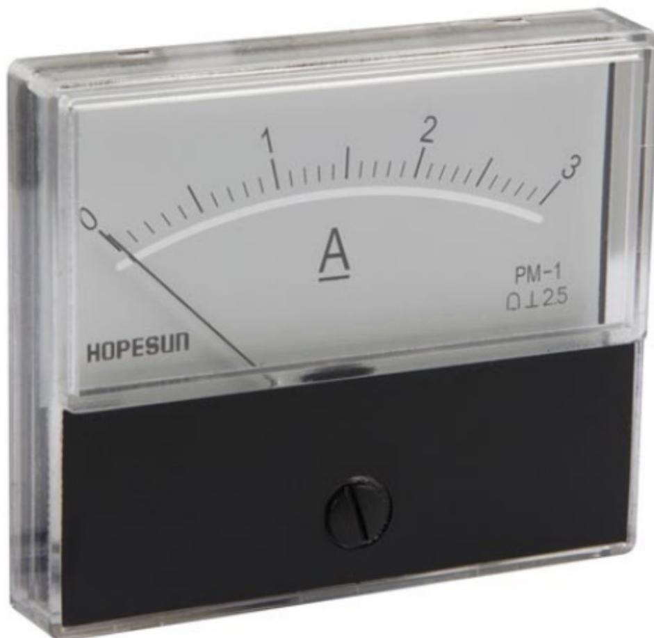
Amperometro analogico da pannello con portata fondo scala: 3 A corrente continua, vite per regolazione dello zero, dimensioni: 71 x 60,5 mm. Classe 2.5.
