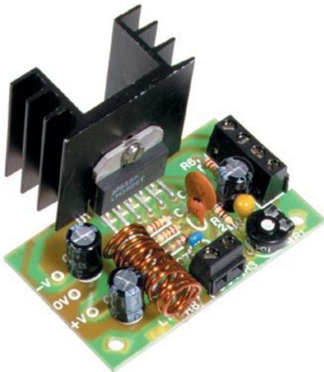
Finale B.F. in grado di erogare una potenza di 60 watt RMS su 4 ohm o di 50 watt su 8 ohm con una tensione di alimentazione duale di 28 volt per ramo (4 ohm) o di 35 volt (8 ohm). Il circuito utilizza il nuovissimo integrato monolitico National LM3886 in grado di erogare nei picchi una potenza di ben 150 watt. La distorsione armonica totale del finale
