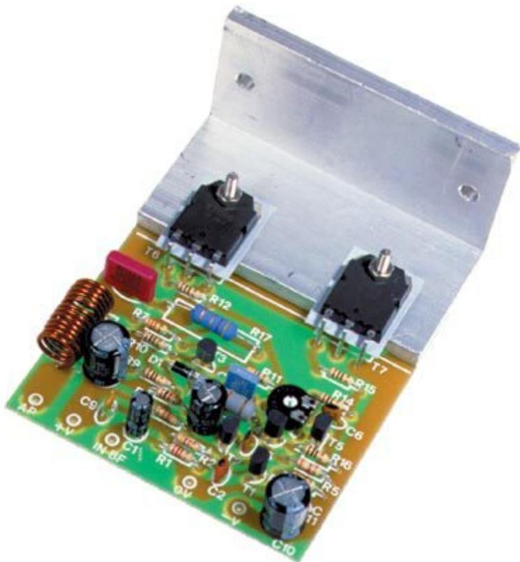
Compatto modulo HI-FI a mosfet in grado di erogare una potenza di 100 watt su 8 ohm e di 150 watt su 4 ohm con una tensione di alimentazione duale di 50 volt per ramo. Il modulo, che utilizza una coppia di mosfet Hitachi, presenta una distorsione inferiore allo 0,1 per cento ed una banda passante compresa tra 5 e 80.000 Hz.
