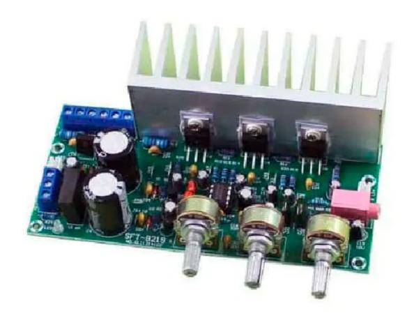
Basato sul TDA2050 e due TDA2030, questo amplificatore dispone di una uscita da 32 watt per i bassi, uscita da 18 watt per canale destro e 18 watt canale sinistro, presa jack 3,5 mm per ingresso audio, potenziometri di regolazione (volume, bassi e alti), uscita ausiliaria 12 Vdc - 1,5 A (può essere utile per alimentare piccoli lettori MP3 o altro) e dissipatore di calore. Alimentazione: alternata 12+12 V (può essere utilizzato un trasformatore 2x12 Vac 50 VA), dimensioni scheda
