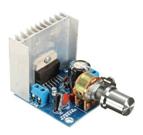
Amplificatore audio basato sul chip TDA7297. È in grado di erogare una potenza massima 15+15 watt su 8 ohm. Dispone di potenziometro per la regolazione del volume direttamente sulla scheda. Alimentazione: da 9 a 12 Vdc (12 Vdc 2 A per ottenere 2x15 watt), potenza di uscita: 2x15 watt, dimensioni (mm): 52x46x42. Particolarmente indicato per essere utilizzato con piccoli lettori MP3.
