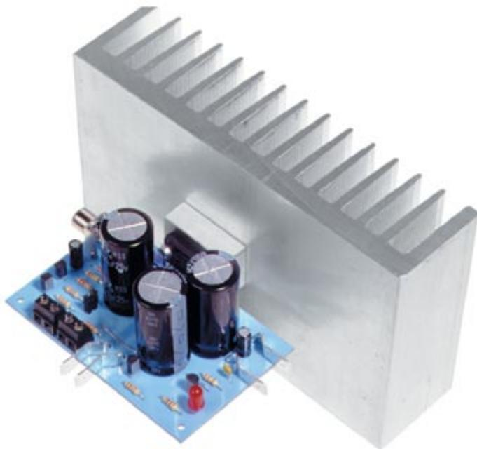
Amplificatore audio di potenza realizzato utilizzando un unico integrato Philips con stadio finale dinamico: normalmente eroga 40 watt su 4 ohm, ma in presenza di picchi, quando la musica sale improvvisamente di volume, sviluppa fino a 70 W, dando all'ascoltatore l'impressione di avere un ampli decisamente potente. Alimentazione a 12 volt. Il kit comprende tutti i componenti, la basetta forata e serigrafata, l
