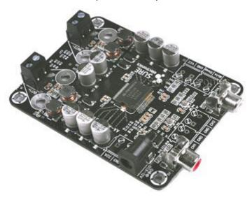
Compatto amplificatore audio in classe T da 15+15 watt, funzionante ad alimentazione singola e in grado di pilotare due altoparlanti passivi da 4/8 ohm di impedenza. Basato sull'integrato TA2024, non necessita di dissipatore di calore. Singola alimentazione a 12 volt, dispone di ingressi MUTE e SLEEP, protezione da sovratemperatura e cortocircuito. La confezione comprende solo l'amplificatore montato e collaudato.
