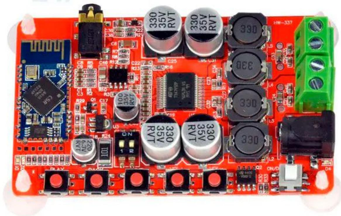
Amplificatore audio 2x50 watt con modulo Bluetooth 4.0 che permette di riprodurre i file audio provenienti da smartphone, tablet o altro dispositivo. È particolarmente adatto per pilotare due altoparlanti con 8 ohm di impedenza, ma è possibile utilizzare anche altoparlanti con impedenza da 4, 6 e 16 ohm.
