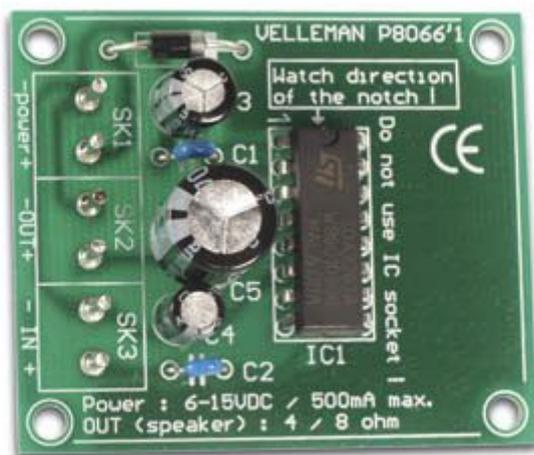
Compatto amplificatore di bassa frequenza per impieghi generali. Potenza massima di 3 watt, possibilità di alimentare il dispositivo con una tensione compresa tra 6 e 15 volt.
