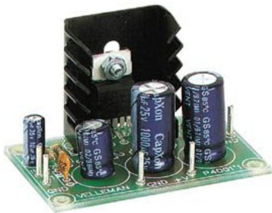
Questo piccolo amplificatore è costruito intorno al circuito integrato TDA 2003, capace di erogare 4 W rms su 4 Ohm. Il circuito integrato è completamente protetto da sovraccarichi e da cortocircuiti. Funziona con ampia gamma di tensioni di alimentazione.
