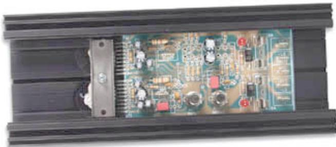
Amplificatore mono/stereo da 200W estremamente compatto e robusto. Sensibilità di ingresso selezionabile, protezione termica, contro i sovraccarichi, cortocircuiti e inversione di polarità della tensione di alimentazione. Il contenitore metallico funge anche da dissipatore di calore.
