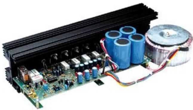
Questo Kit è la versione mono dell'amplificatore K4020, ma è fornito senza contenitore. Sono inclusi dissipatore di calore e trasformatore. Ideale per installazioni in disco bar e sistemi di altoparlanti attivi.
