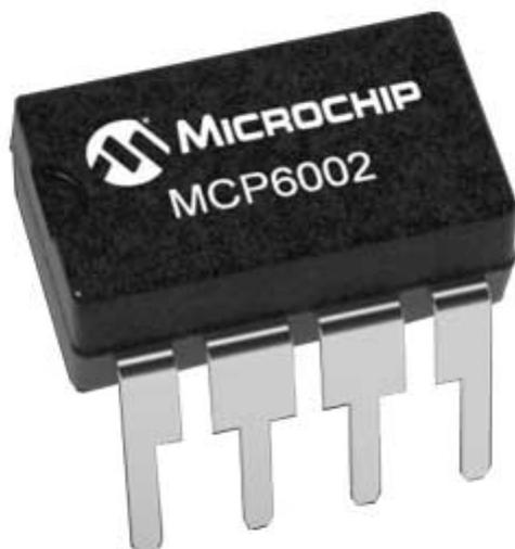
L'MCP6002 è un doppio amplificatore operativo per impieghi generici con ingresso/uscita rail-to-rail. Questo amplificatore ha un GBWP (Guadagno in larghezza di banda tipico) tipico di 1 MHz con una corrente di riposo di 100  $\mu$ A. Alimentazione: da 1,8 V a 6 V, case PDIP 8 pin.
