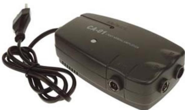
Dispositivo dotato di 1 ingresso che permette di amplificare, fino a 18 dB, il segnale ricevuto dall'antenna. Controllo del guadagno regolabile manualmente. Alimentazione 230 Vac.
