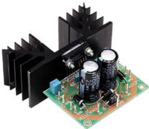
Questo piccolo amplificatore è costruito intorno al circuito integrato TDA 1521, capace di erogare una potenza massima di 2 x 15 W rms (su 4 Ohm) e di 2 x 10 W rms (su 8 Ohm). Il circuito integrato è completamente protetto da sovraccarichi e cortocircuiti. Per l'alimentazione dell'amplificatore, non sono necessari raddrizzatori, condensatori o filtri aggiuntivi e possono essere collegate direttamente tensioni alternate.
