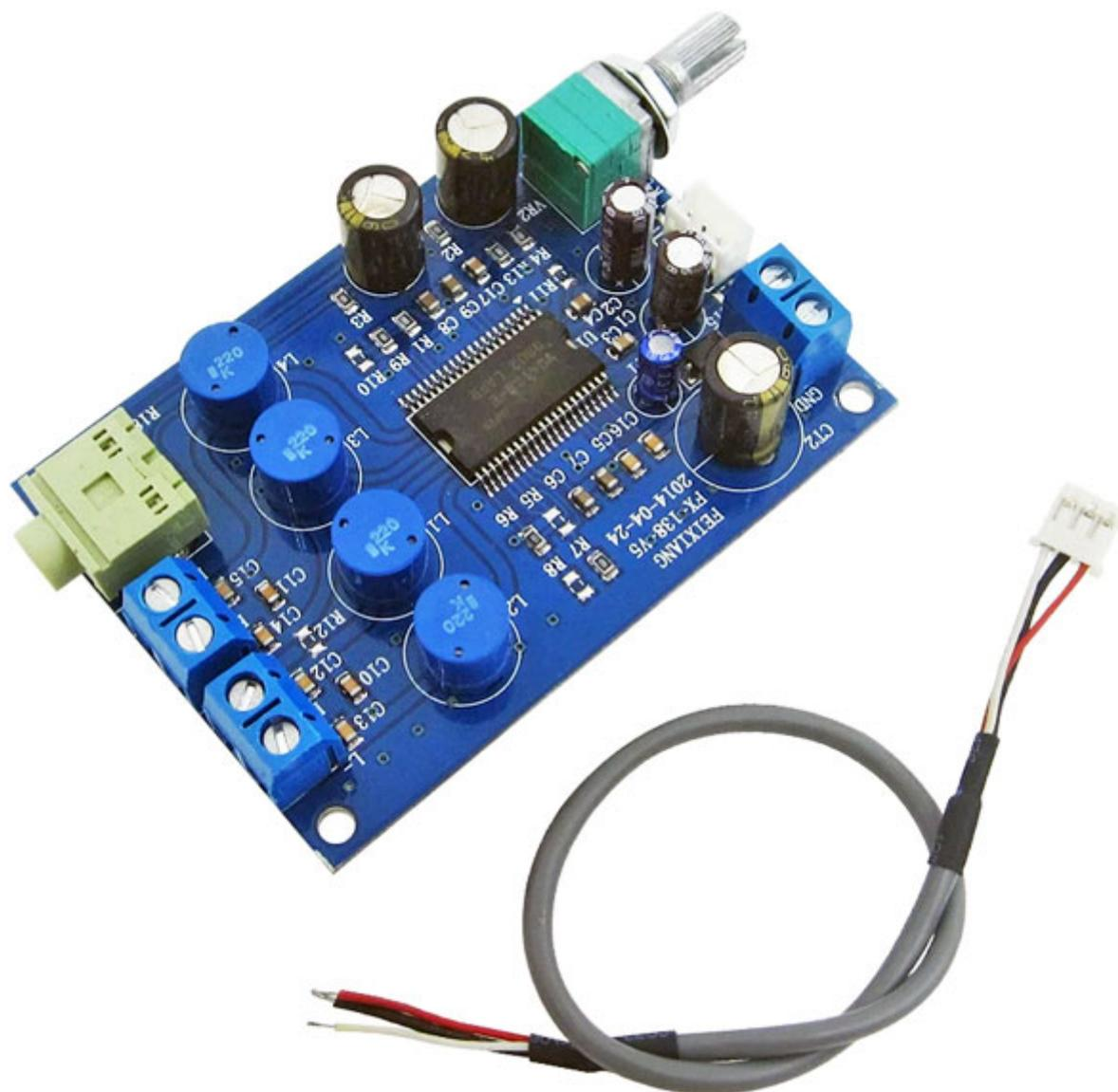
Amplificatore audio stereo in classe "AB" basato sul chip YDA138. È in grado di erogare una potenza massima di 10+10 watt su 8 ohm e 20 watt (mono) su 4 ohm. Dispone di potenziometro per la regolazione del volume direttamente sulla scheda; uscita cuffia su presa jack stereo 3,5 mm; morsettiera a vite per alimentazione e uscite audio (canale destro e sinistro). Alimentazione: 12 Vdc, dimensioni (mm): 70,5x50,5x16.
