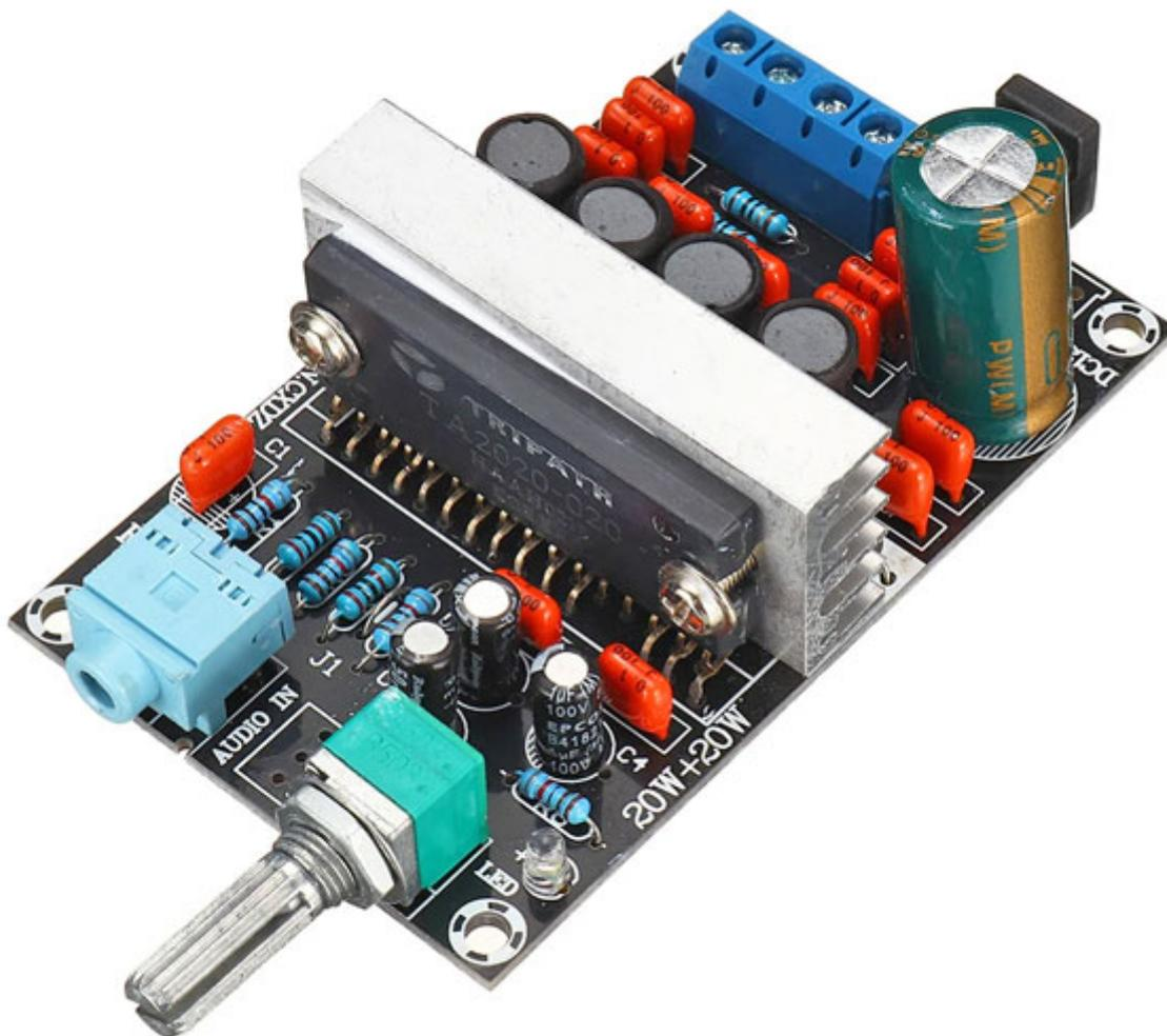
Amplificatore audio stereo in classe "T" basato sul chip TA2020-020. È in grado di erogare una potenza massima di 20+20 watt su 4 ohm e 13+13 watt su 8 ohm. Dispone di potenziometro per la regolazione del volume direttamente sulla scheda; LED di stato per alimentazione; ingresso audio su presa jack stereo 3,5 mm; morsettiera a vite per alimentazione e uscite audio (canale destro e sinistro), dissipatore di calore. Alimentazione: da 9 a 15 Vdc, dimensioni (mm): 82x50x28.
