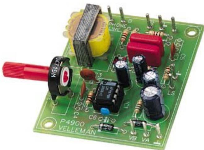
Questo amplificatore telefonico può essere utilizzato autonomamente con altoparlante, (ad esempio per ascoltare una conversazione telefonica), oppure è possibile connetterne l'uscita a un amplificatore o a un mixer (utile, ad esempio, in studi radiofonici).
