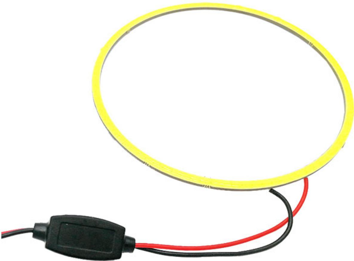
Anello dimmerabile con apposito driver (vedi prodotti correlati) con LED COB a emissione di luce bianca fredda e ricoperti da gomma siliconica. Diametro: 80 mm, alimentazione: da 10 a 24 VDC, consumo: circa 3 watt, vita media: 50.000 ore. Può essere utilizzato in moltissimi modi, ad esempio per realizzare lampade, fari, illuminazione di prodotti nelle vetrine, ecc.
