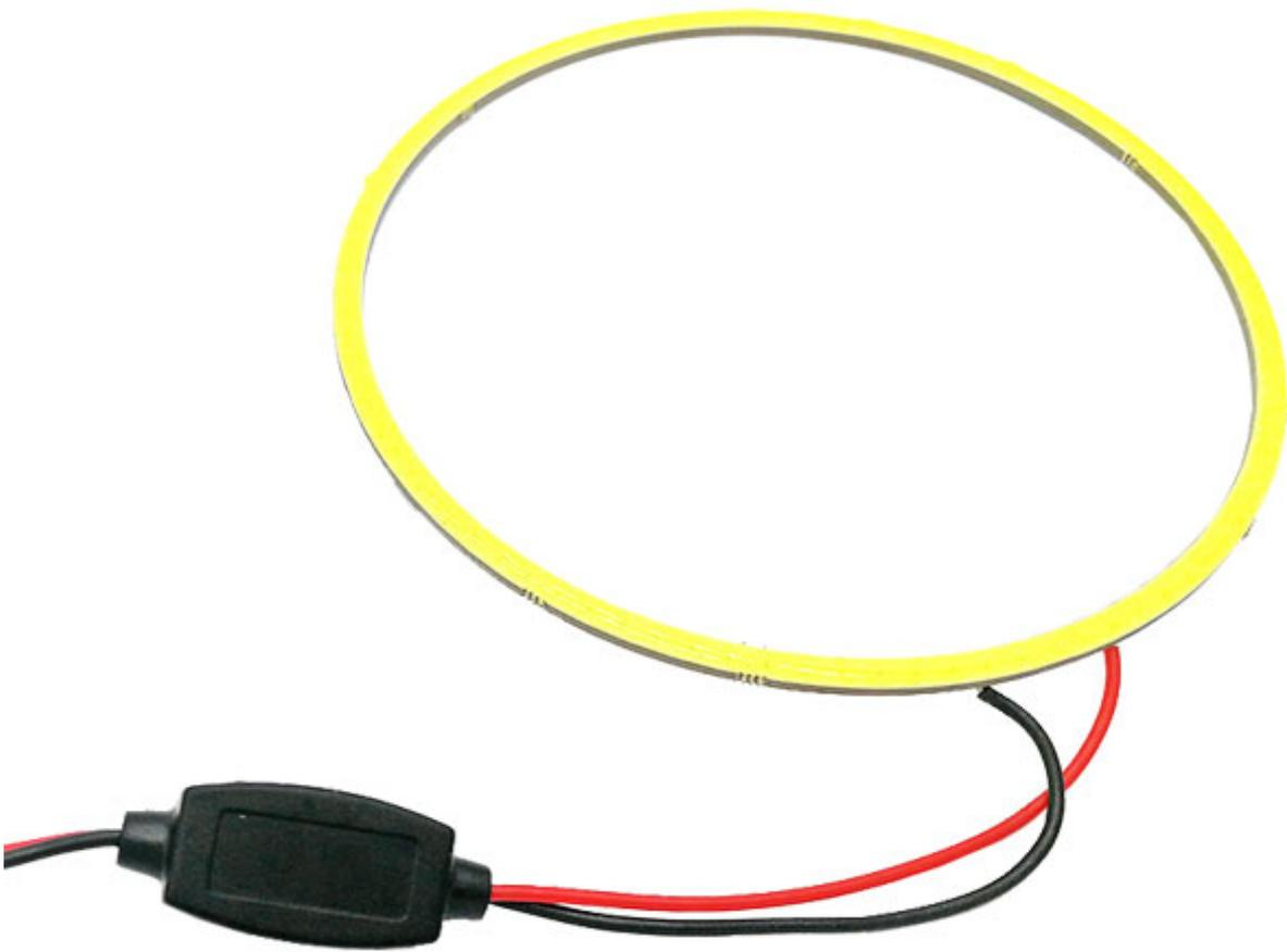
Anello con LED COB a emissione di luce gialla e ricoperti da gomma siliconica. Diametro: 80 mm, alimentazione: da 10 a 24 VDC, consumo: circa 3 watt, vita media: 50.000 ore. Può essere utilizzato in moltissimi modi, ad esempio per realizzare lampade, fari, illuminazione di prodotti nelle vetrine, ecc.
