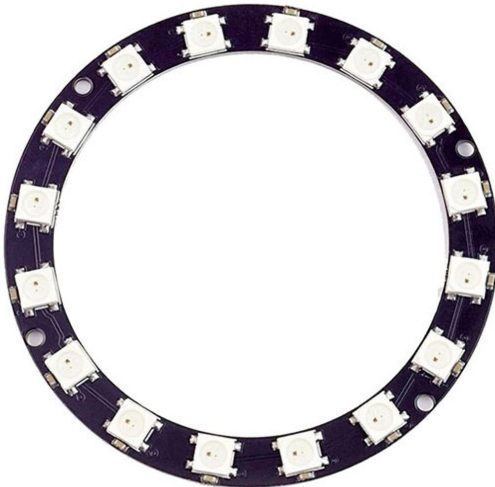
Questo anello a tecnologia Neopixel è composto da 16 diodi LED RGB completamente gestibili, ciascuno in grado di creare 256 sfumature di colore, dando vita a una stupefacente gamma di oltre 16 milioni di colori. La comunicazione avviene tramite un canale dati seriale One-Wire, consentendo il controllo attraverso microcontrollori come Arduino, PIC, mbed e altri.
