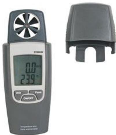
Strumento portatile per la misura della velocità e della temperatura del vento. Differenti unità di misura; gamma di misurazione da 0,4 a 20 m/s; da -10°C a +50°C; risoluzione 0,1 m/s, 0,1°C. Alimentazione 3 batterie 1,5 V AAA (incluse).
