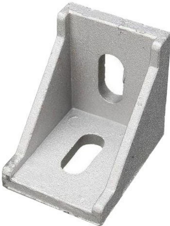
Angolare in alluminio pressofuso da utilizzare come raccordo per i profilati 20x20. Dimensioni (mm): 28x28x20. Utilizzato per realizzare il telaio della stampante 3D4040.
