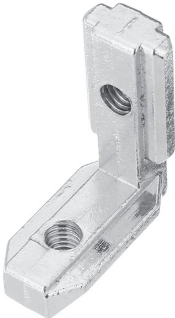
Staffa ad L, in lega di zinco, perfetta per realizzare una giunzione ad angolo retto tra due profili in alluminio serie 2020. L'inserimento nelle scanalature dei profili permette di nascondere la squadretta rendendo la giunzione priva di sporgenze. Fissaggio mediante 2 grani M4 (non inclusi).
