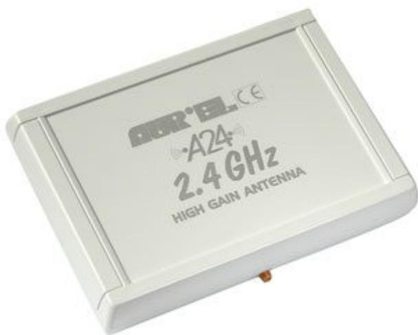
Antenna compatta che garantisce un elevato guadagno nella banda dei 2,4 Ghz e applicabile su qualsiasi superficie. Utilizzabile sistemi Rx/Tx a 2.4 GHz. Guadagno: 10 dB, Connettore d'uscita: SMA femmina, Banda: 2.2÷2.6 GHz, Impedenza: 50 Ohm, Corpo: P.V.C. bianco, Dimensioni: 188.5x133.5x39.5 mm. (Codice Aurel: A24, 650200740)
