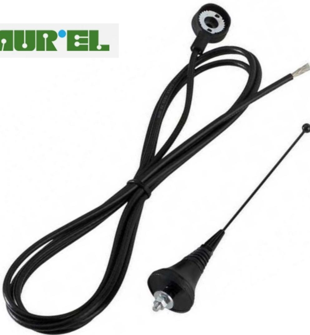
Antenna verticale a stilo per uso esterno. Fornita con 2,5 metri di cavo coassiale 50 Ohm RG58 MIL-C17. Utilizzabile con sistemi TX e RX a 430-440MHz. Impedenza 50 ohm, corpo PVC nero, dimensioni 34x75 mm.
