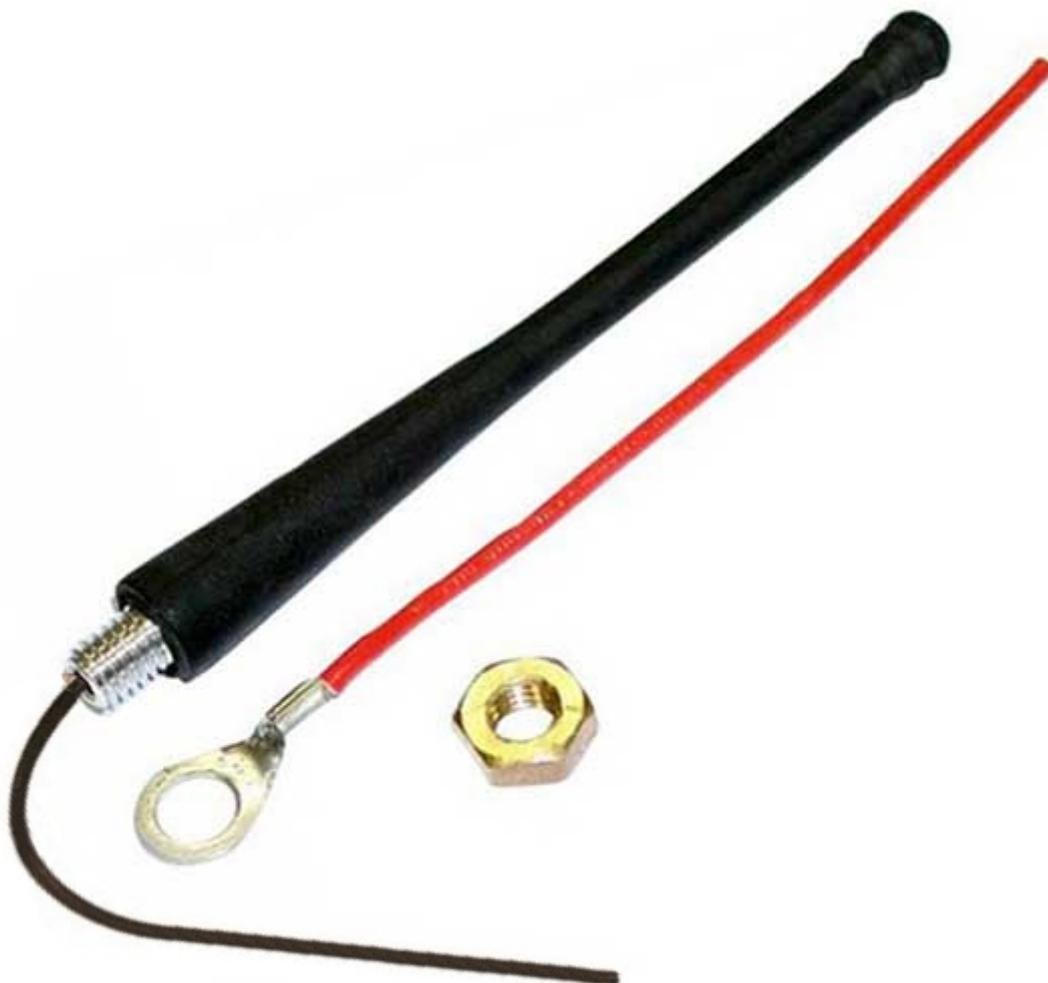
Antenna a STILO per contenitori plastici e metallici. Può sostituire un'antenna in quarto d'onda. Resistente alle sollecitazioni meccaniche e alle intemperie. Utilizzabile con sistemi con TX e RX a 430-440MHz. Impedenza 50 ohmm, corpo in gomma nera, dimensioni 10x90 mm. Fornita con capocorda per eventuale massa aggiuntiva.
