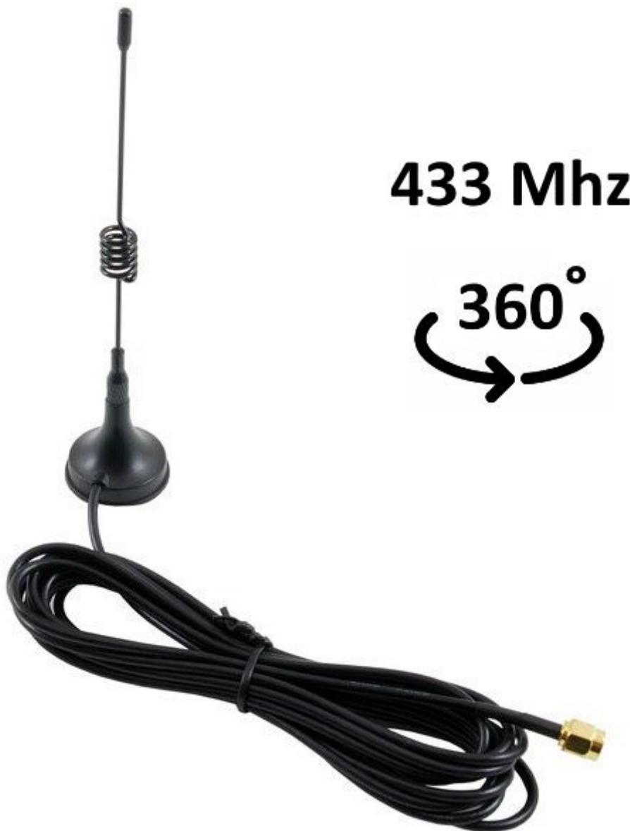
Antenna verticale a stilo 433 MHz. Fornita con 3 metri, connettore SMA e base magnetica. Utilizzabile con sistemi TX e RX a 430-440 MHz. Dimensioni (mm): 150x30x4.
