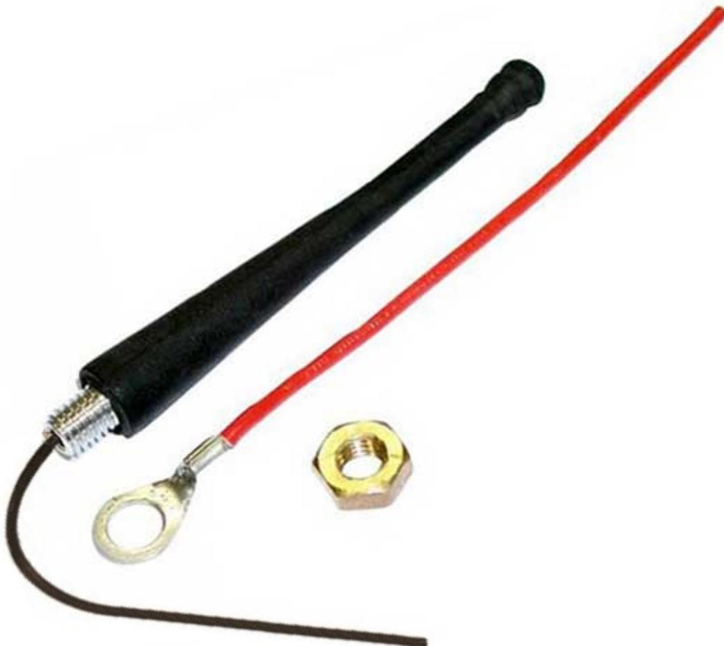
Antenna a STILO per contenitori plastici e metallici. Resistente alle sollecitazioni meccaniche e alle intemperie. Utilizzabile con sistemi TX e RX a 860-870MHz. Impedenza 50 ohm, corpo in gomma nera, dimensioni 10x90mm, Fornita con capocorda per eventuale massa aggiuntiva.
