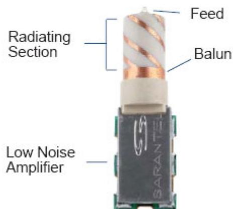
Antenna attiva GPS omnidirezionale ad alto guadagno, con amplificatore a basso rumore e dalle dimensioni estremamente ridotte (15x49x13 mm). Compatibile con la maggior parte dei ricevitori GPS. Peso: 10 grammi. Particolarmente indicata per ricevitori con un guadagno d'ingresso da 20 a 30 dB.
