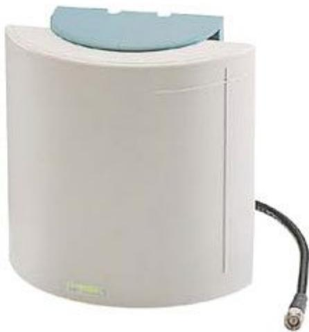
Antenna direttiva a 2,4 GHz da esterno. Applicabile a parete grazie all'apposito supporto che ne permette cavo schermato tipo RG58 di 30 cm. Impedenza 50 Ohm; guadagno 8.5 dB; connettore SMA.
