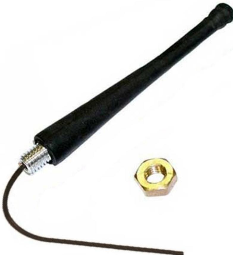
Antenna a STILO per contenitori plastici e metallici. Può sostituire un'antenna in quarto d'onda, con resistenza alle sollecitazioni meccaniche e alle avverse condizioni climatiche. Utilizzabile con sistemi TX e RX 860÷870 MHz. Banda: 860÷870 MHz, Impedenza: 50 Ohm, Corpo: Gomma nera, Dimensioni: 10x90 mm (Codice Aurel: T8, 650200607).
