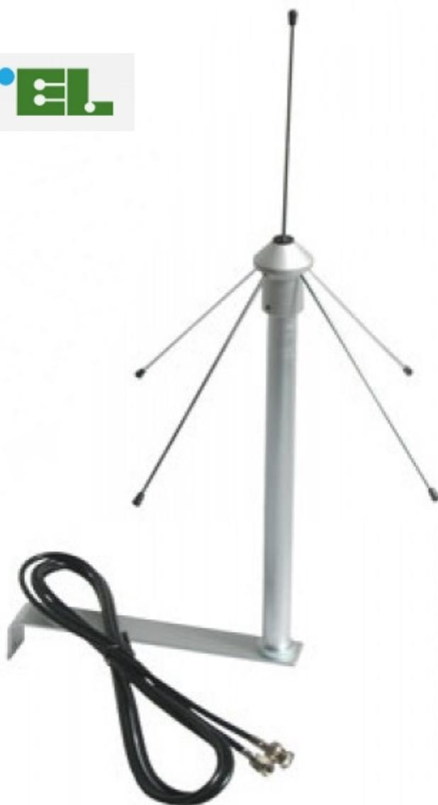
Antenna Ground Plane per applicazioni di controllo remoto. Fornite con staffa di fissaggio [205x30x35 mm] e 2.50 mt di cavo coassiale 50 Ohm RG58 MIL-C17 terminato dal lato antenna con connettore "F". Utilizzabile con: sistemi TX e RX a 430÷440 MHz. Banda: 430÷440 MHz, Impedenza: 50 Ohm, Corpo: Alluminio, Radiali in ottone cromato, Dimensioni: 455x270 mm (Codice Aurel: GP 433, 650200313).
