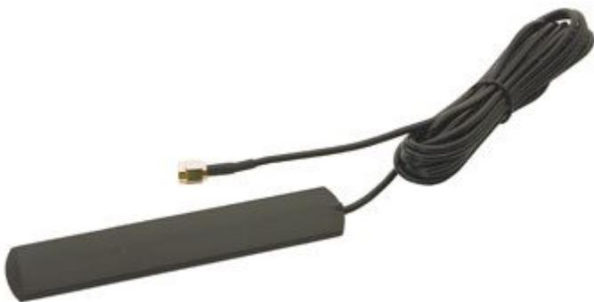
Antenna GSM ad elevata sensibilità. Cavo RG174 lunghezza 3 metri, connettore SMA, quadriband, compatibile con le reti GSM con frequenza di funzionamento di 850/900/1800/1900 MHz.
