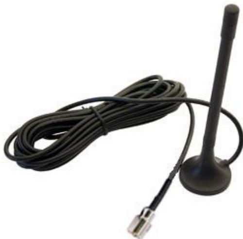
Antenna GSM a stilo con base magnetica e 3 metri di cavo. Cavo RG174, connettore FME maschio, altezza stilo 12 cm. Quadriband, compatibile con le reti GSM con frequenza di funzionamento di 850/900/1800/1900 MHz.
