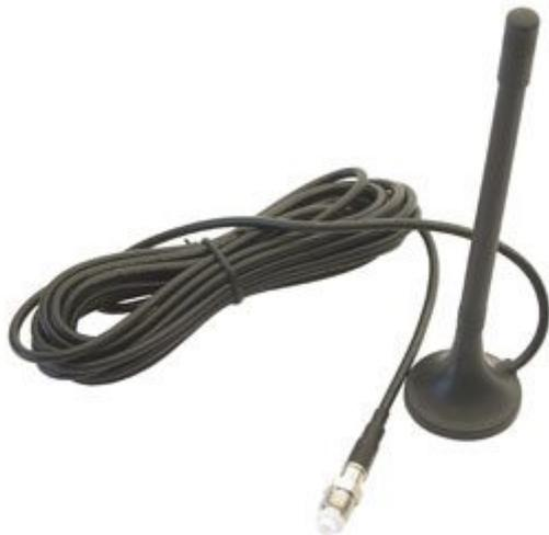
Antenna GSM a stilo con base magnetica e 3 metri di cavo. Cavo RG174, connettore FME femmina, altezza stilo 12 cm. Quadriband, compatibile con le reti GSM con frequenza di funzionamento di 850/900/1800/1900 MHz.
