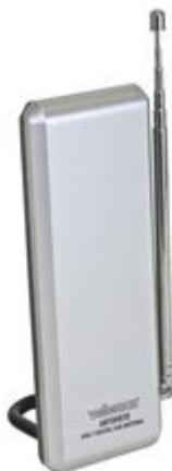
Antenna attiva portatile, ideale per essere utilizzata con il nostro ricevitore [DVBTUSB](#). Amplificatore a basso rumore, elevata direzionalità. Frequenza 47÷870 MHz. Guadagno 20dB ±3dB. Completa di base d'appoggio, cavo d'antenna e cavo d'alimentazione USB da 1,5m.
