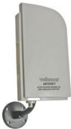
Può essere montata su muro o palo sia in posizione orizzontale che verticale. Amplificatore a basso rumore. Elevata direzionalità. Filtro trappola FM e filtri VHF e UHF integrati. Contenitore Waterproof resistente ai raggi UV. Frequenza: UHF 470÷870 MHz; VHF 46÷88 MHz, 108÷230 MHz. Guadagno 20dB ±3dB. Completa di alimentatore, 3 m di cavo, accessori per il montaggio e adattatore Power inserter.
