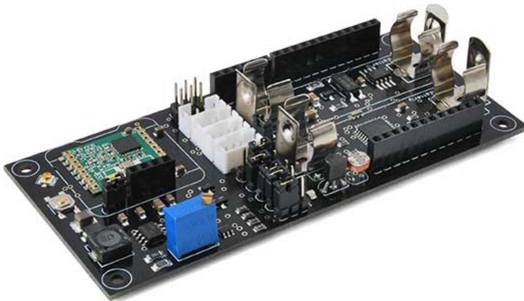
Antennino (il nome Antennino è la combinazione di Antenna e Arduino) è una board a basso costo e a bassa potenza basata sul chip Atmel, quindi compatibile al 100% con il tradizionale IDE Arduino. La board integra sensori e bus di comunicazione per acquisire informazioni esterne, nonché un link wireless per comunicare con l'esterno. A seconda di come viene equipaggiata, può funzionare sia da modulo remoto che da collettore di informazioni (gateway).
