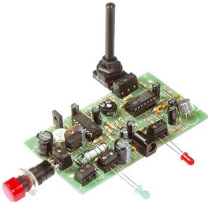
Rileva gli spostamenti d'aria causati dall'apertura di una porta o di una finestra, segnalando l'intrusione tramite il buzzer interno o fornendo un comando d'allarme ad una centralina. Ideale per abitazioni e, come avvisatore notturno anti-intrusione, per camera da letto: posto, ad esempio, su un mobile o sul comodino, avvisa chi sta dormendo se qualcuno si è introdotto in casa.
