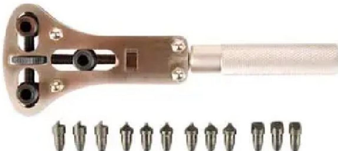
Utensile a 3 griffe adatto per aprire e chiudere ogni tipo di cassa d'orologio con fondo a vite. Posizione dei punzoni regolabile da 17 a 34 mm. Completo di 12 punzoni intercambiabili (3 per tipo) per aprire casse con differenti tipi di tacche.
