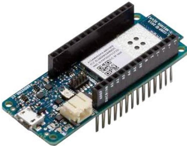
Arduino MKR1000 offre le funzionalità di Arduino Zero con l'aggiunta del Wi-Fi e antenna su PCB. È basato su SmartConnect di dispositivi Atmel Wireless, progettati specificamente per progetti e dispositivi IoT. L'ATS
