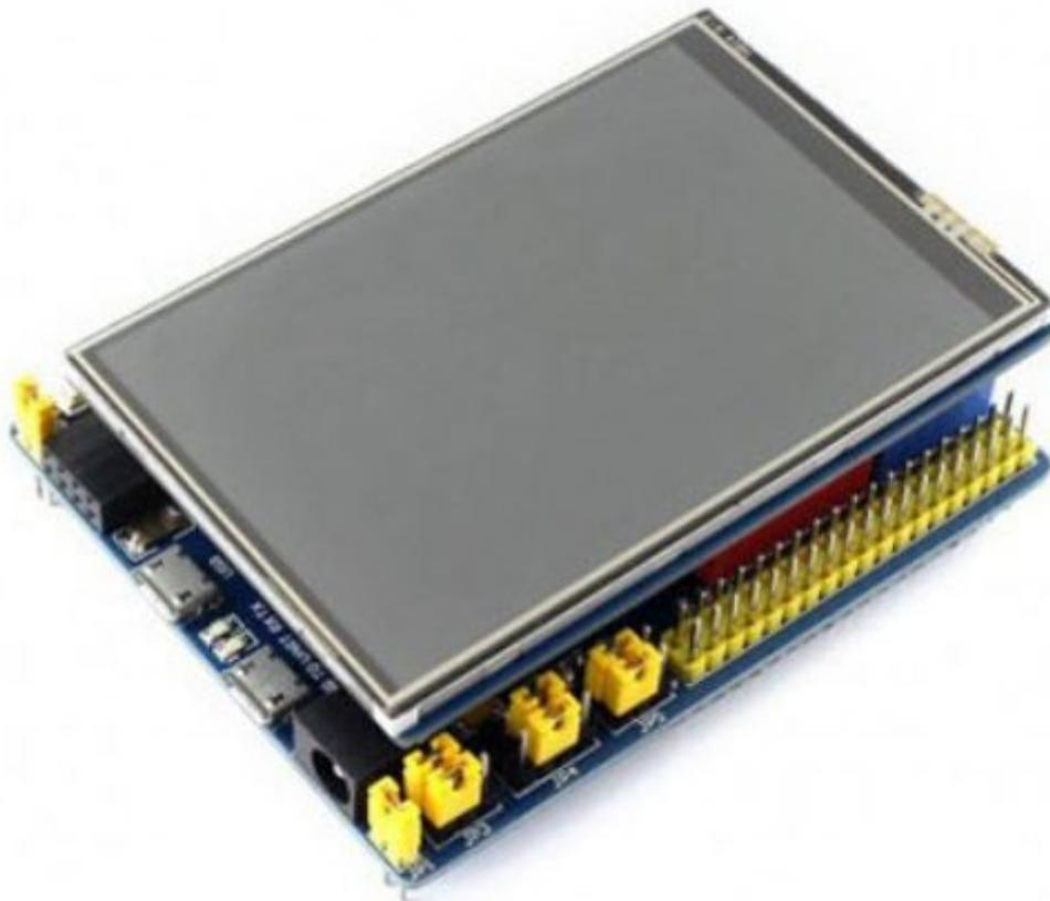
Shield per Arduino Uno costituito da un display TFT LCD con touch screen resistivo da 3,5", controller grafico ILI9486, risoluzione 480x320 pixel, 65.000 colori, retroilluminazione a LED bianchi, slot per SD card e interfaccia SPI. Ideale per realizzare applicazioni che necessitano di visualizzare dati, foto e video. Indicato per essere interfacciato ad Arduino Uno/Mega è anche compatibile con Fishino, Nucleo, Xnucleo, MAKERUNO e UNO PLUS (vedere prodotti correlati).
