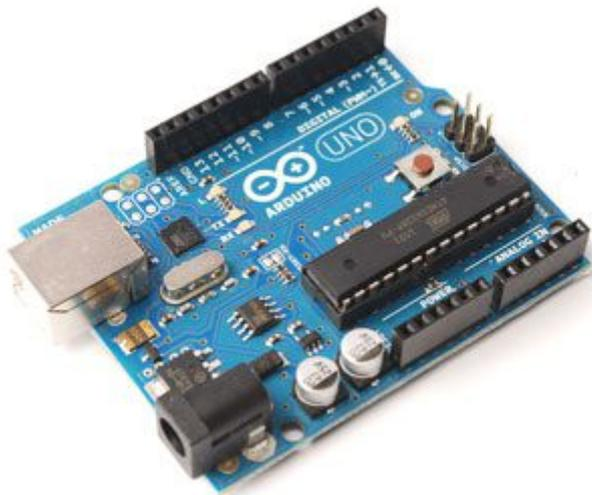
Arduino Uno è una scheda elettronica basata sul microcontrollore Atmega328. Dispone di 14 ingressi/uscite (6 possono essere utilizzate come uscite PWM), 6 ingressi analogici, un cristallo oscillatore a 16 MHz, una connessione per alimentazione, un header ICSP e un pulsante di reset.
