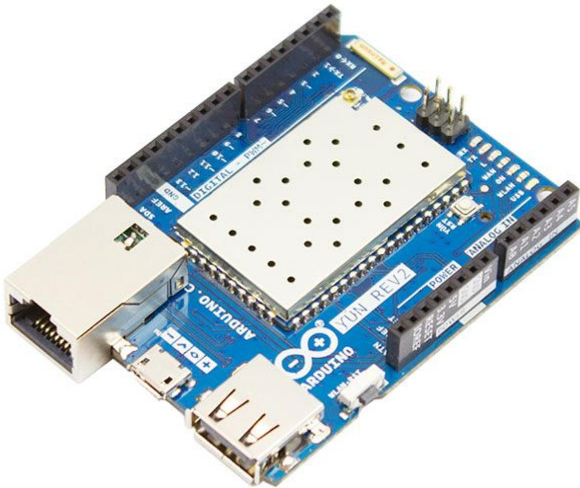
Arduino Yún rev. 2 è una scheda Arduino diversa da qualsiasi altra. Si programma come un Arduino Leonardo ed infatti utilizza lo stesso processore ATmega32U4, ma la sua caratteristica principale è che ha anche un processore aggiuntivo: un Atheros AR9331, con Linux e lo stack wireless OpenWRT.
