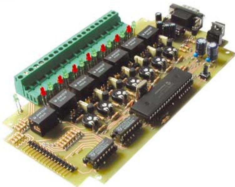
Collegato alla porta seriale delle centraline WS2300, WS2305, WS2308 e WS2355 della La Crosse Technology, permette di attivare utilizzatori elettrici quando i parametri meteorologici raggiungono una determinata soglia o escono da una finestra di valori preimpostata. È l'ideale per riavvolgere una tenda da esterno motorizzata quando soffia un vento troppo forte o per abbassare le tapparelle a comando elettrico quando piove o grandina. La scatola di montaggio non comprende il contenitore.
