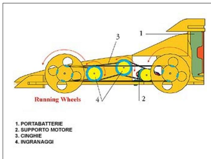
Modello motorizzato in legno facilmente realizzabile da chiunque. Consente di prendere confidenza con i sistemi di trasmissione del moto, dagli ingranaggi alle pulegge. Non richiede l'impiego di un saldatore né di alcun tipo di colla. Dimensioni (mm): 240x85x95.
