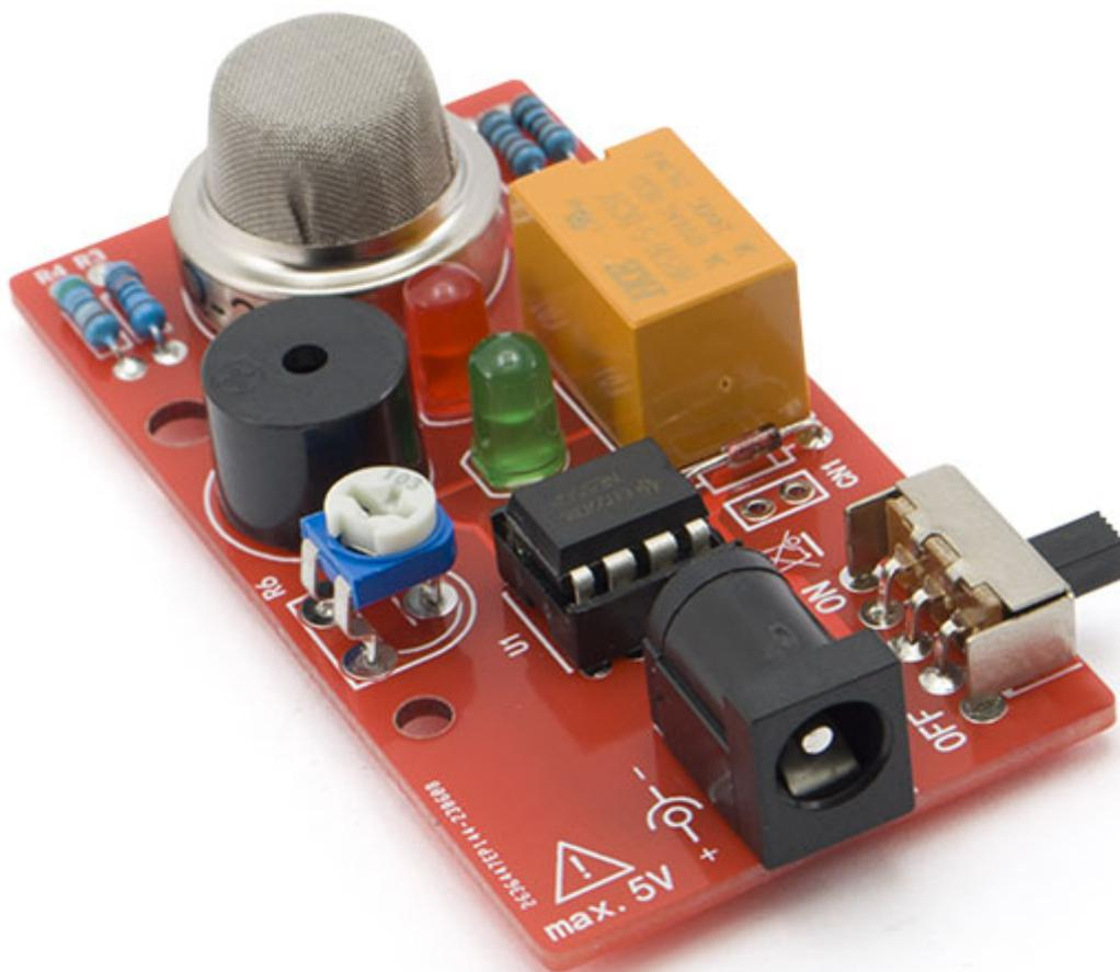
Questo dispositivo di rilevamento gas è progettato per fornire avvisi acustici e visivi nel caso in cui la concentrazione di gas Butano, GPL, Propano e Idrogeno superi la soglia di sicurezza in un determinato ambiente. Inoltre, offre la possibilità di attivare dispositivi tramite un relè in situazioni di emergenza **Saldatura richiesta per il montaggio. Le istruzioni sono incluse e sono disponibili in italiano.**
