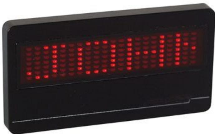
Cartellino elettronico in grado di visualizzare fino ad un massimo di 50 caratteri. Particolarmente indicato per applicazioni commerciali ed ovunque sia necessario visualizzare un nome o un marchio. Basso consumo, alta luminosità e facilità di programmazione rappresentano le caratteristiche più significative di questo dispositivo. Quattro differenti velocità di scorrimento.
